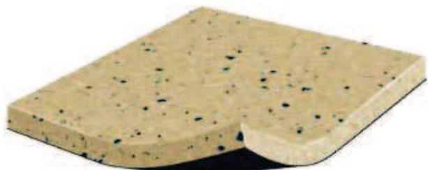
MIPOLAM ELEGANCE EL5 es un pavimento vinílico conductor, según la norma EN 1081 ( $10^4 \leq Rt \leq 10^6$  Ohms) disponible en rollos de 2m de ancho. Su construcción homogénea de 2mm de espesor con encapsulado de los gránulos en masa del producto y el esmalte conductor, le confieren propiedades eléctricas conductoras óptimas e invariables en el tiempo, así como una excelente resistencia a las cargas estáticas y rodantes (el suelo está clasificado 34-43 según la norma EN 649).
