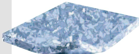
MIPOLAM TECHNIC EL5 es un pavimento vinílico electroconductor, flexible, homogéneo con una resistencia eléctrica de  $5 \times 10^4 \leq Rt \leq 10^6$  Ohms (EN 1081), disponible en losetas. El carbono conductor que contiene posibilita unas propiedades conductoras permanentes. Cumple con las normas EN 649.
